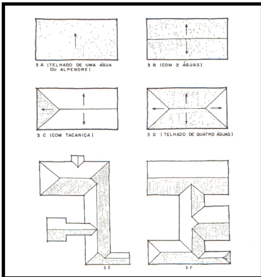
Figura presente no website da CEAR, CERÂMICAS LTDA , descrevendo alguns tipos de telhados.
